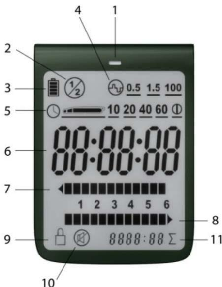
1. **Le capteur optique** allume l'écran LCD pendant 10 secondes dans une salle obscure lorsque l'on appuie sur n'importe quel bouton.
